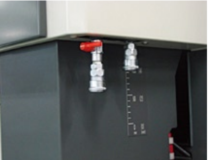
在步距加工时,用于在电极和工件之间喷油的 喷油口(照片为EA12A)
