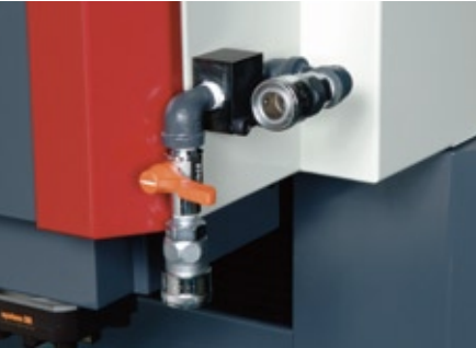
步距加工时在极间喷射加工液 (照片为EA8A机型)
