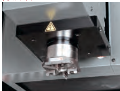
机头侧电极装夹 (EROWA-ITS装夹规格)
