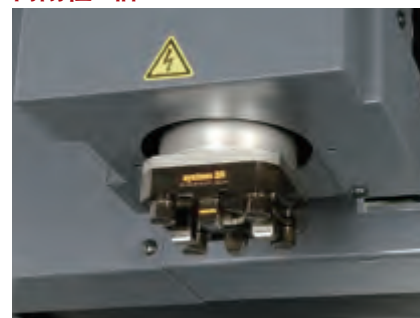
适应找电极平行及分度加工 从中心可液喷出 (3R-MACRO装夹规格)
