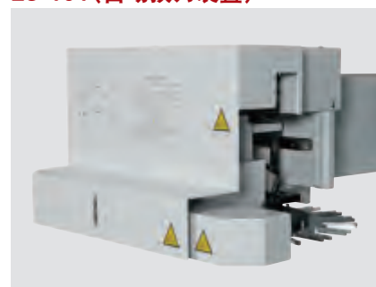
可交换最多10根电极 对应使用复数电极的连续加工
