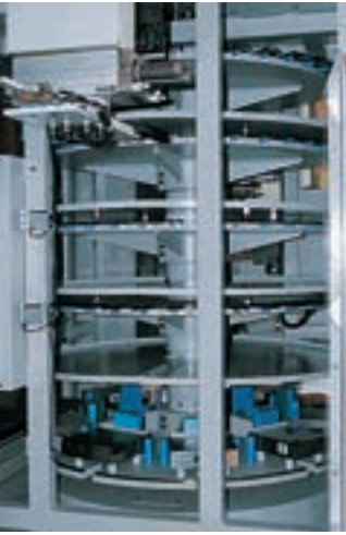
<图示为5层储存库规格> (10个工件、144个电极规格)
