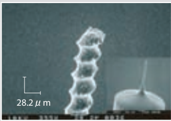
图示为使用修整仪(WEDG)进行加工的实例
